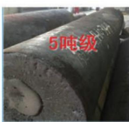
图 2.工业化规模 5 吨级 SIMP 钢锭
