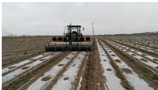
图1 PPC地膜机械化铺设
