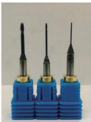
图 1.义齿加工用金刚石涂层刀具
