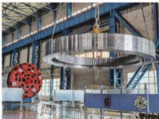
图 1.首套自研 \phi 3\text{m} 级主轴承成套产品
