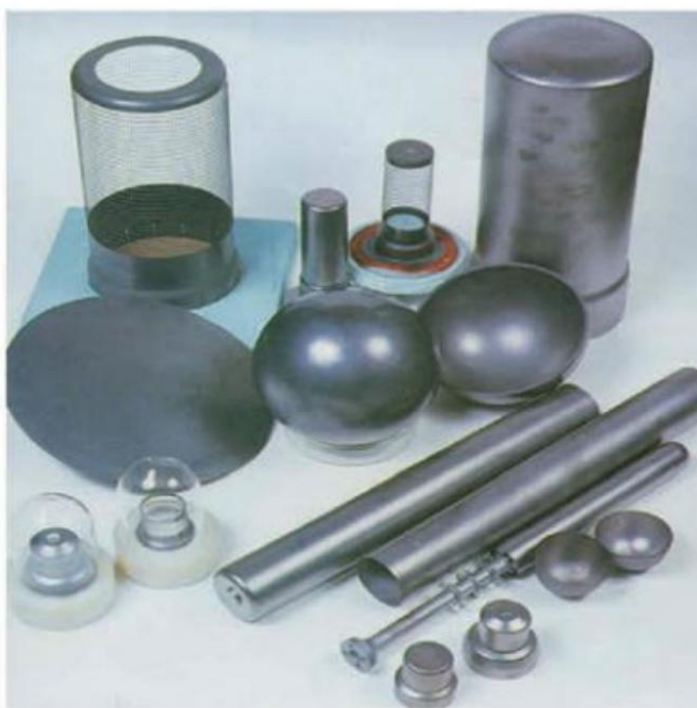
图 1.热解石墨材料及制件
