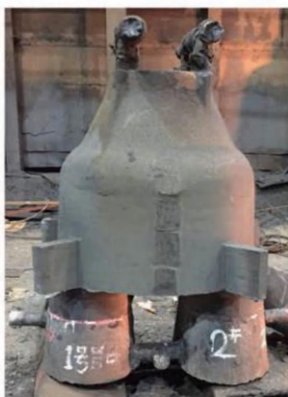
图 1.3 吨阀体毛坯件
