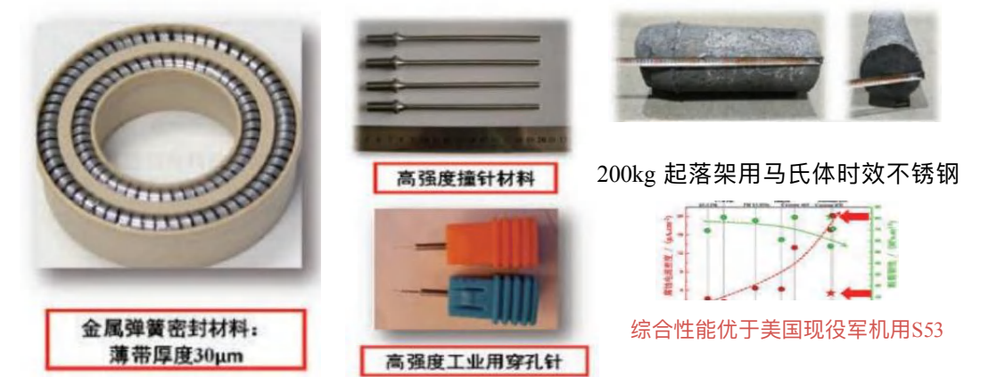
图 1.2800MPa 级马氏体时效钢相关制品 图 2.200Kg 级飞机起落架用马氏体时效不锈钢及其性能对比
