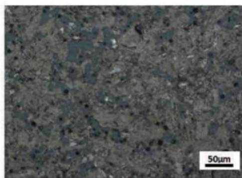
图 2.浸树脂石墨复合材料
