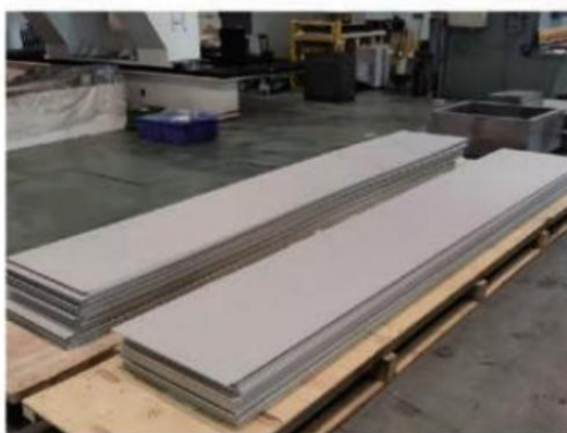
图 1. 铝基碳化硼中子吸收材料板材 图 2. 铝基碳化硼中子吸收材料板材与焊接筒
