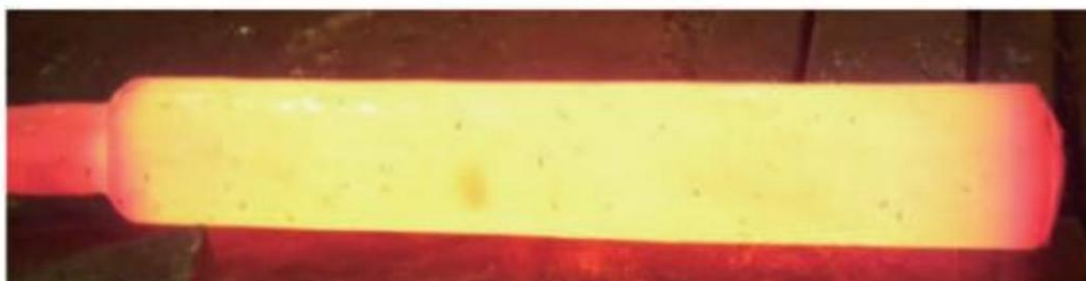
图 2.直径 250mm 辊造大棒材
