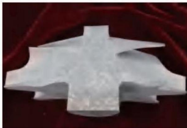
图 2.整体细晶叶轮截面晶粒形貌
