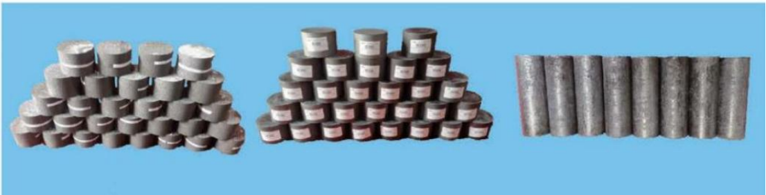
图 1.高强 C/C 复合材料固体火箭发动机热端部件
