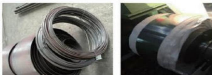
图 2 直径为 0.1mm 以及厚度为 0.03mm 的丝带材制品
