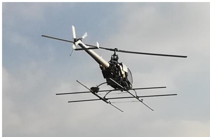
图1 智能化重载荷物探专用旋翼无人机
