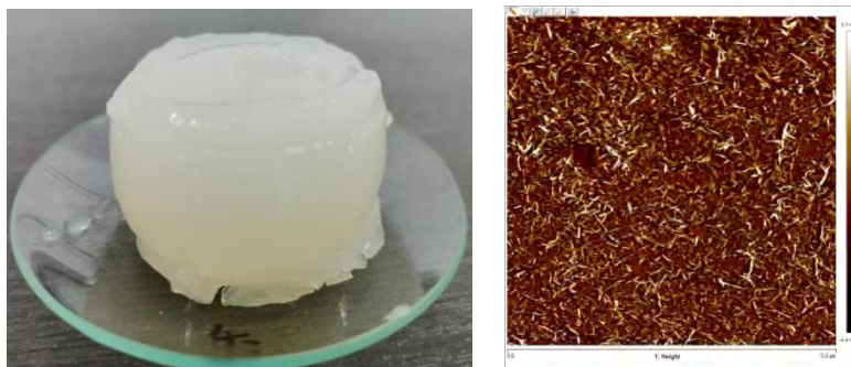
图 2 5%纳米纤维素晶水分散凝胶样品及其 AFM 图
