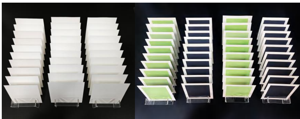
图2 钨锆电解质薄膜和钨锆电解质支撑型单电池
