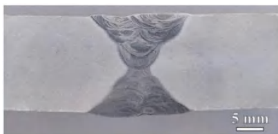
20 mm厚7075铝合金焊缝
