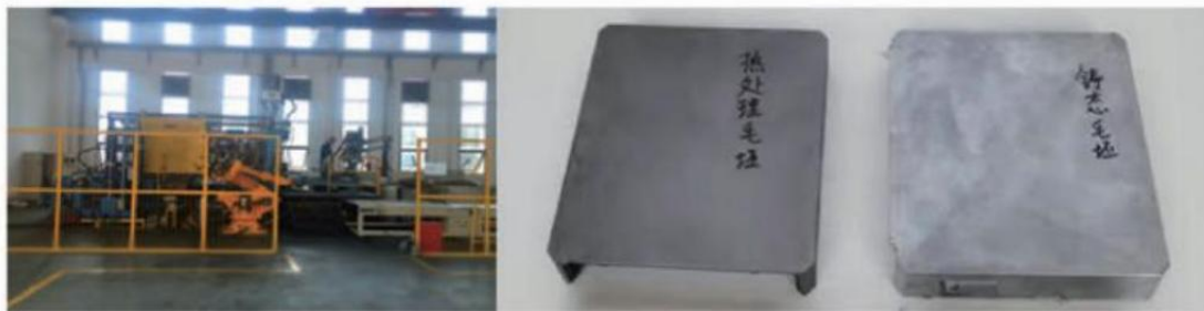
图 4.压铸小微型电子通讯设备壳体
