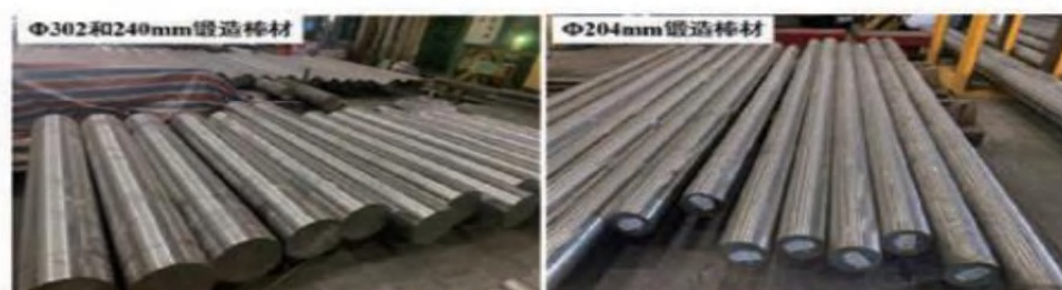
图 1.各种规格的 CN-1515 锻造棒材
