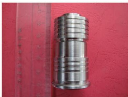
图 1.高硅镍铜合金轴套
