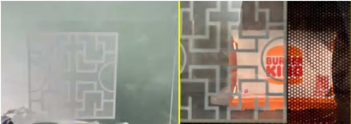
图2 屏蔽膜可任意图形化
