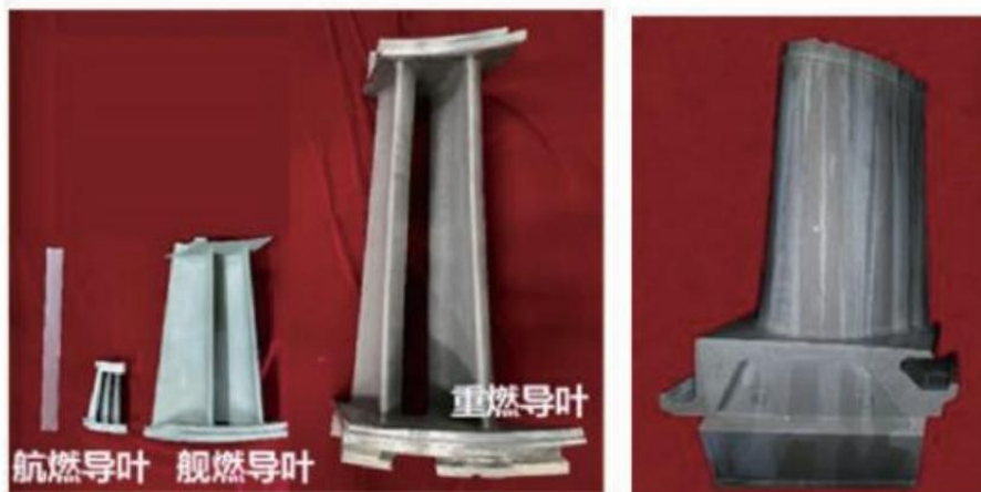
图 1.研制的透平(发动机)等轴晶叶片 图 2.研制的重型燃气轮机一级动叶定向叶片 主要指标(特点):
