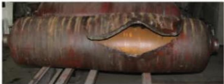
图 1.JQ100 制备的气瓶完成了爆破试验-爆破压力满足指标要求，断口呈韧性断裂
