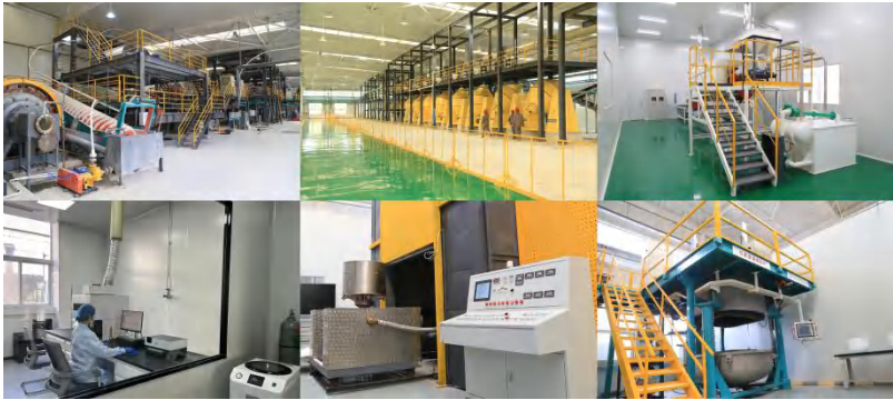
图 1 4N8 级超高纯石英砂千吨级工业试验线
