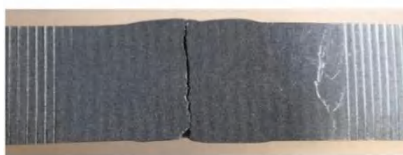
接头断裂形貌
