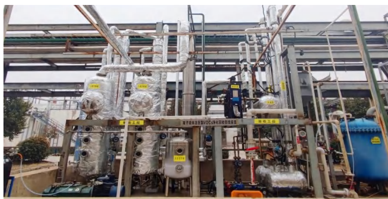
图2 40万Nm 3 /h离子液体法含氯VOCs净化回收侧线装置
