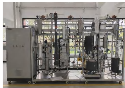
图2 15\text{Nm}^3/\text{h} 高压氨分离连续评价装置
