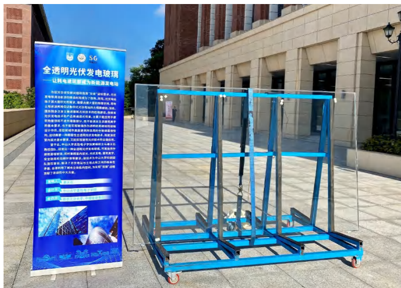
图 2 平米级隐形全透光伏发电玻璃样品
