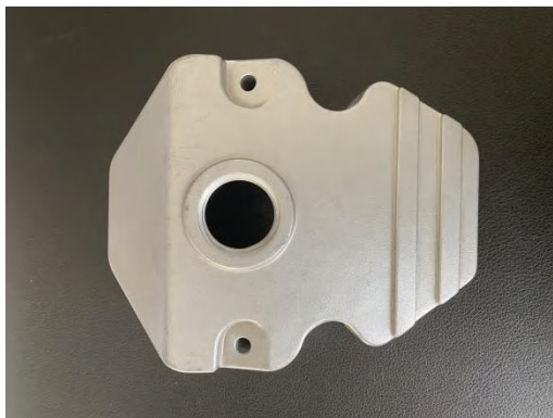
图1 稀土镁合金柴油发动机缸 图2 稀土镁合金汽车中控扶手台骨架
