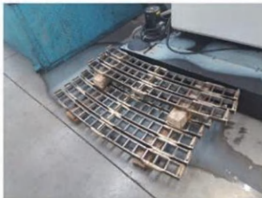
图 3.首套自研中 8\text{m} 级主轴承G1 级 \phi 120\text{mm} 大型滚子产品
