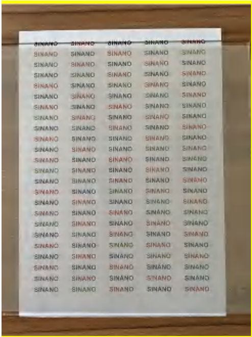
图3 屏蔽膜透明度高
