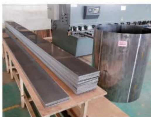
图 1. 铝基碳化硼中子吸收材料板材 图 2. 铝基碳化硼中子吸收材料板材与焊接筒
