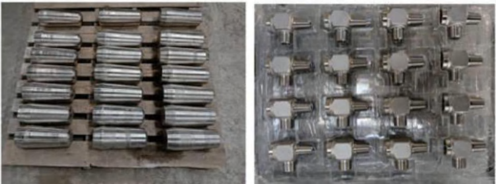
图 1.超纯 316L 铸锭 2.超纯 316L 阀门
