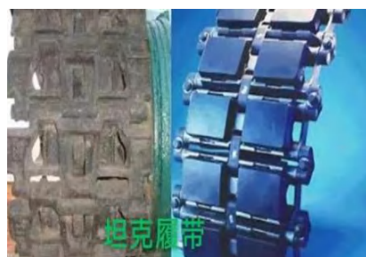
图 2 某军方项目防腐处理
