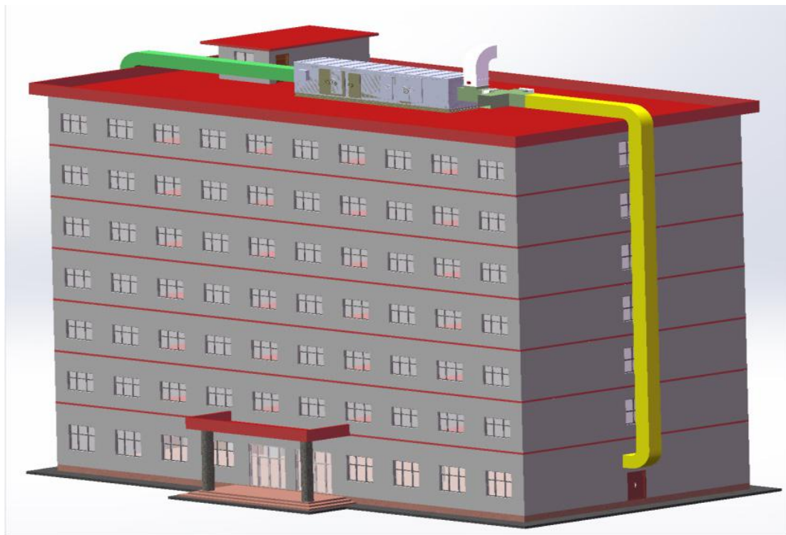
建筑物核生化灾害防御系统布局示意图
