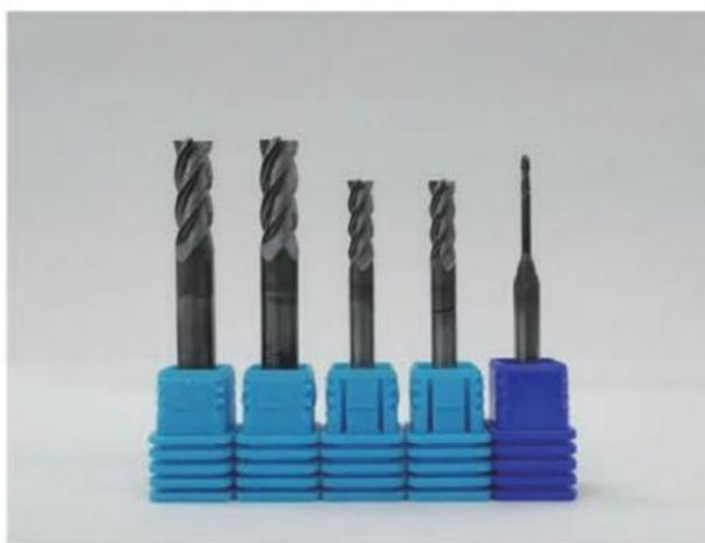
图 2.石墨加工用金刚石涂层刀具
