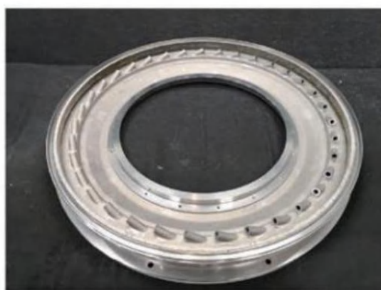
图 1.航空发动机Ti3Al 合金低涡导叶内环
