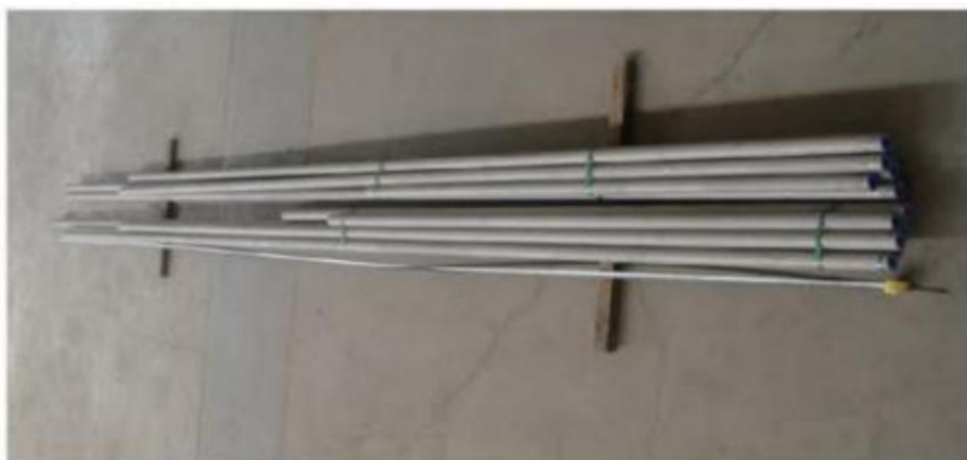
图 5. \phi 60.3\text{mm} 管材(U26 合金)
