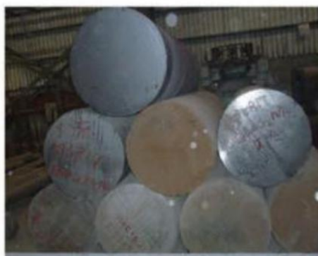
图 1.900mm 以上直径大断面连铸圆坯 图 2.直径 1200mm 空心连铸
