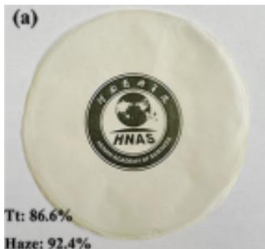
图 1 所制备的高透高雾光管理薄膜紧贴标志物的状态
