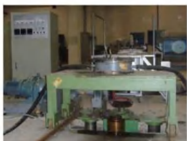
图 1.低压脉冲磁场半连续铸造机
