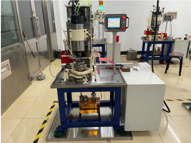
图1 PL-3型控温润滑球棒式摩擦疲劳试验机照片
