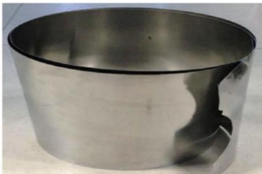
图 1.80.2mm 规格 GH3625 合金带材
