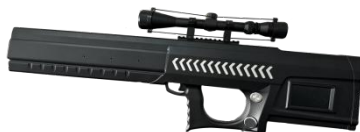
图 3 手持式无人机侦测测向设备 图 4 便携式侦测打击一体化设备
