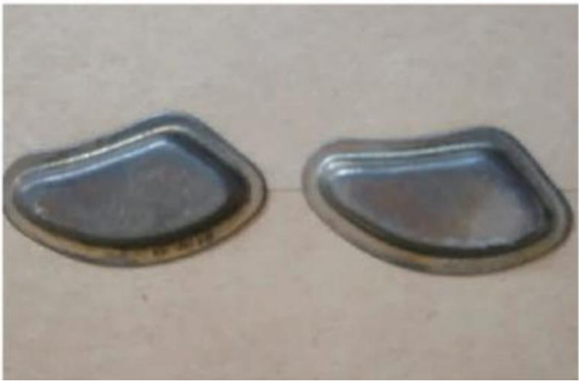
图 2 航空发动机 GH3625 合金冷却导管
