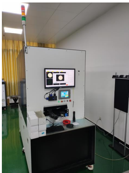
图 1 镜片瑕疵检测设备
