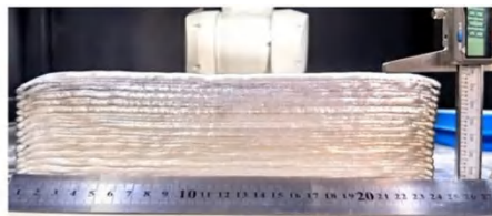
7B55铝合金电弧增材墙体形貌
