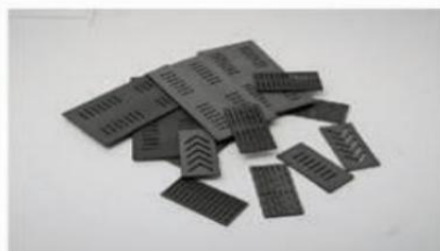
图 1.制造臭氧水用 BDD 电极
