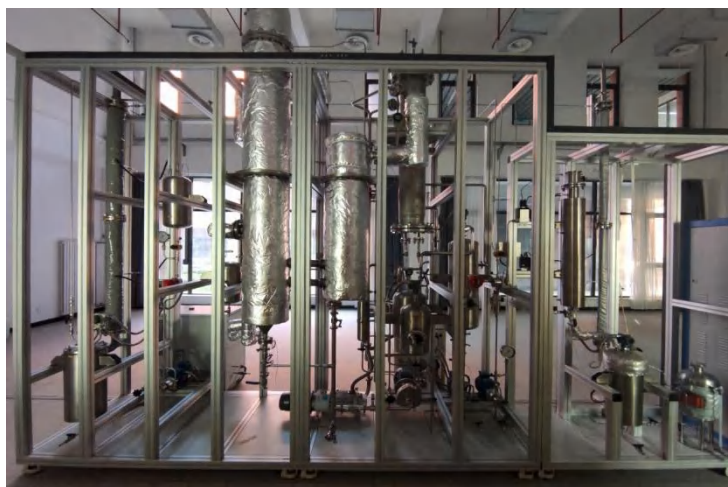
图1 1Nm 3 /h离子液体发生含氯VOCs吸收降膜解吸连续 评价装置
