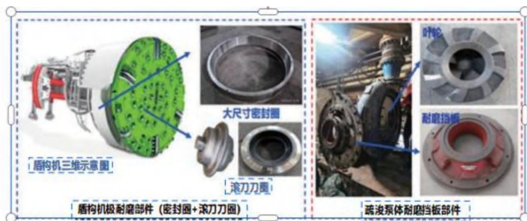
图 1.盾构机和疏浚泵关键极耐磨部件工程应用情况
