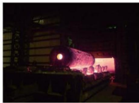
图 1.900mm 以上直径大断面连铸圆坯 图 2.直径 1200mm 空心连铸
