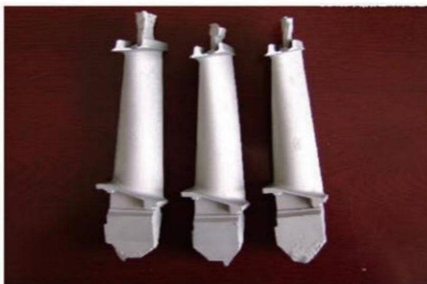
图 1.D0483 单晶合金叶片毛坯件
