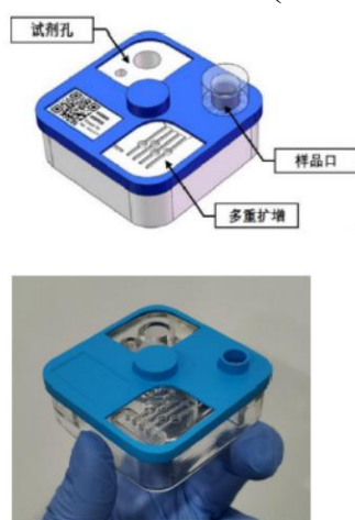
图 1 旋变式微流控芯片 图 2 便携式一体机
