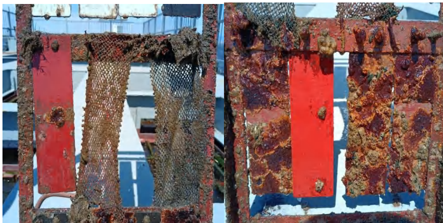
图2红色漆 科研阶段的防污性能
