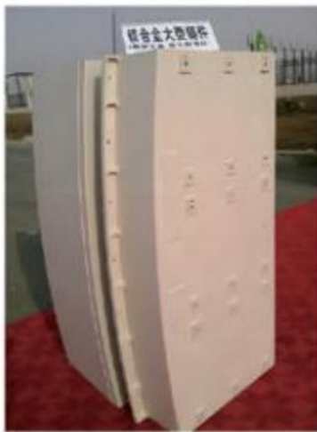
图 1.高强耐热镁合金飞行器舱体
