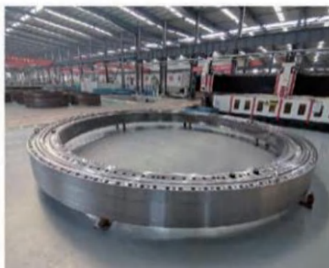
图 2.首套自研 8\text{m} 级主轴承成套产品
