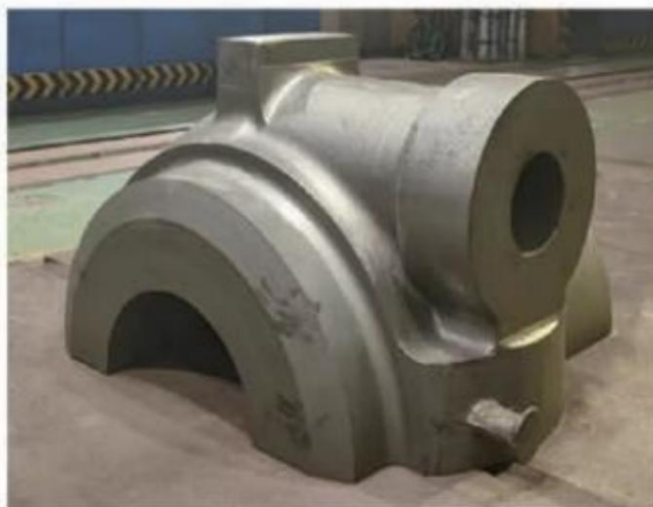
图 2.K325 合金汽缸铸件 12 吨级全尺寸工业试制件
