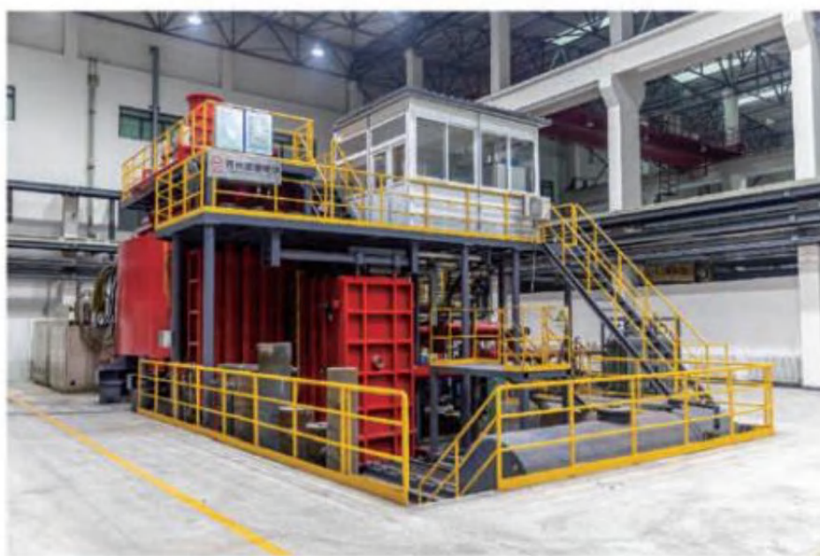
图 1.1 吨真空感应熔铸炉
