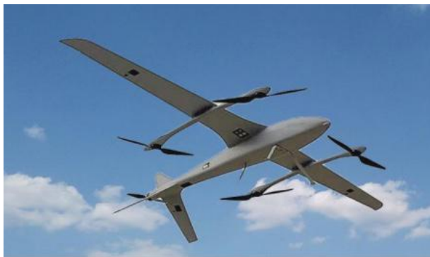
高载重长续航智能复合翼无人机
