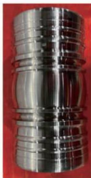
图 2.单脊金属密封构件
