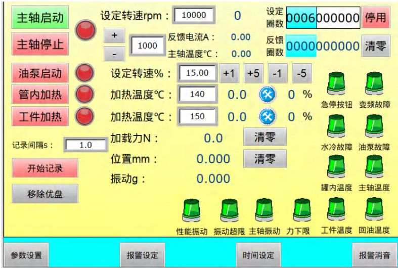
图2 PL-3型控温润滑球棒式摩擦疲劳试验机控制系统操作界面
